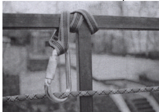
Bild 16: Kürzen einer Bandschlinge durch Umschlingen des Festpunkts
