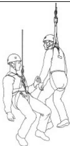
Bild 32: Sternale (vorderseitige) und dorsale (rückseitige) Aufhängung an der Gurtweste
