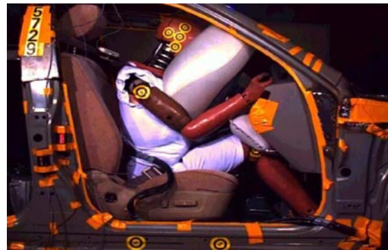
Abbildung 2: Fahrer- und Knieairbag im Moment der vollen Entfaltung, hier bei einem Test. (Foto: Toyota)
