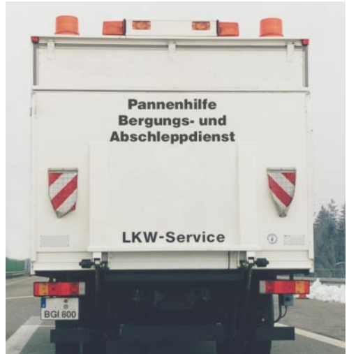
Bild 3: Warnleuchten in Doppelblitztechnik
