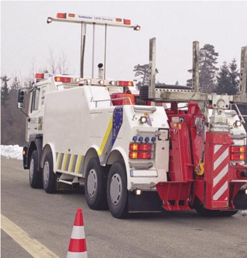
Bild 2: Teleskopierbare, weit sichtbare Warnleuchten
